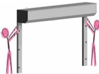
Bei breiteren Rollladen empfehlen wir das Aufstellen des Rollladens immer mit zwei Personen auszuführen. Vermeiden Sie generell eine starke Verdrehung des Kastens über die Schienen. Hier besteht die Gefahr, dass die Lagerschalenzapfen abbrechen. Abgesehen von der daraus resultierenden schwerwiegenden Beschädigung des Rollladens besteht hohe Verletzungsgefahr für die Monteure.
