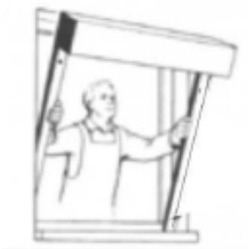
Die Anbringung erfolgt in der Regel von außen, kann aber in Ausnahmefällen je nach Größe und Gewicht auch von innen erfolgen. Vor allem bei Montage von innen ist darauf zu achten, dass entsprechende Sicherheitsmaßnahmen getroffen werden, so dass der Monteur aber auch der Rollladen entsprechend gegen Absturz gesichert sind.
