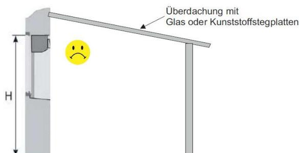
**Bei Montage des Solarrolladens unter einer Überdachung mit Glas oder Kunststoffplatten kann es zu erheblichen Funktionsstörungen kommen. Der Akku muss hier dann ggf. öfters mit einem optional erhältlichen Netzteil nachgeladen werden.**
