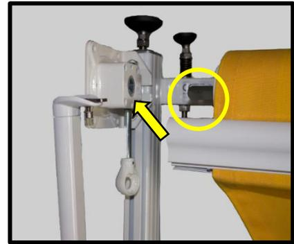
Auf der gegenüberliegenden Seite ist die Tuchwelle mit einem Rundstift ausgestattet. Der Rundstift wird von oben in die Kunststoffaufnahme an der Lagerschale eingedrückt.
