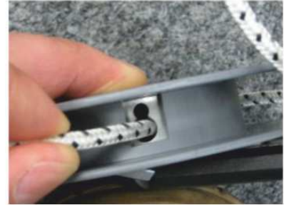
Schnur einmal um die Federdose wickeln und mindestens 3 cm in das größere Loch führen .
