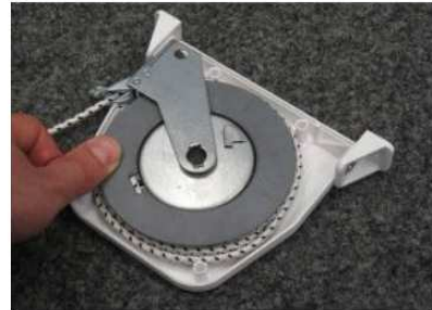
Schnur langsam einziehen lassen danach Gehäuse schließen
