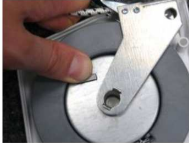
An Schnur ziehen Arretierlasche mit Daumen eindrücken
