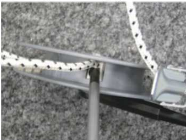
Mit einem Schraubendreher die Schnur in das kleinere Loch drücken
