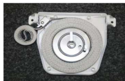
Den Gurt langsam in den Wickler einziehen lassen. Gehäuse danach schließen !
