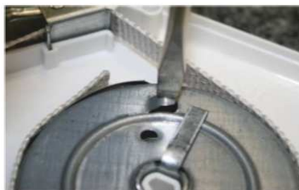
Am Gurt ziehen und die Arretierlasche eindrücken. Die Arretierlasche darf nicht zu tief eingedrückt werden und nicht am Spannhaken schleifen.
