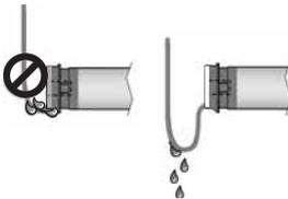
Um zu verhindern, dass Wasser in den Antrieb läuft, sollte das Anschlusskabel **in einer Schleife nach unten** verlegt werden.
