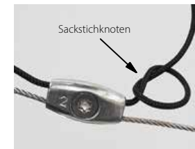
Fangseil mit Sackstichknoten und verschmolzener Schnitt nach der Seilklemme
