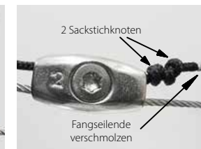
Fangseil mit Sackstichknoten und verschmolzener Schnitt nach der Seilklemme
