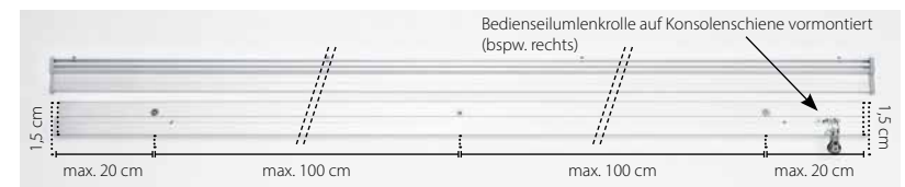
Konsolenschiene Bemaßung Befestigungslöcher
